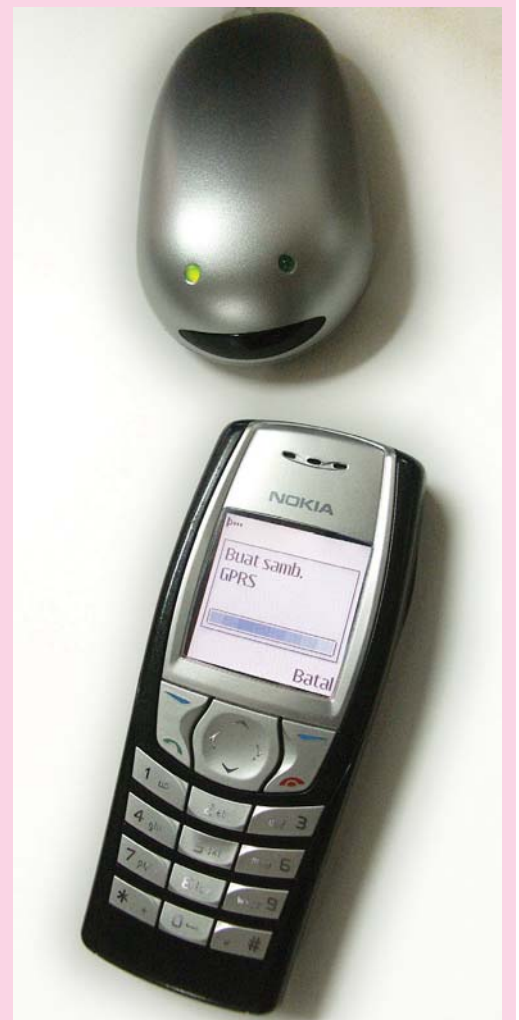
Transceiver ponsel harus tegak lurus dengan jarak tertentu dengan transceiver pada adapter irDA . Kalau tidak, koneksi antara ponsel dan PC tidak akan berjalan mulus.
