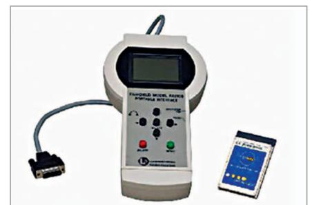
Alat pembaca data pada kotak hitam.
