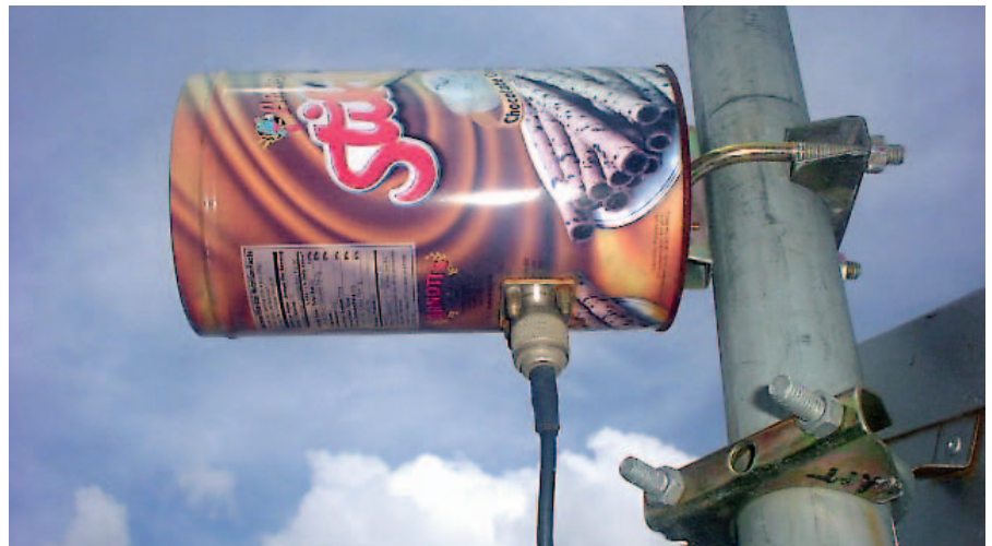
Bentuk antena kaleng yang sudah siap digunakan. Meskipun secara fisik masih terlihat sederhana, namun kinerjanya tidak diragukan lagi.
